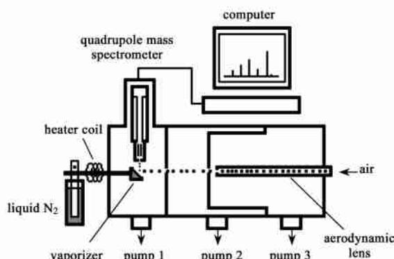
图 10 热脱附粒子束质谱示意图<sup>[52]</sup>
