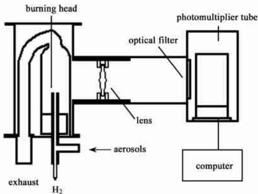
图2 火焰光度法气溶胶中硫酸盐在线分析仪<sup>[34]</sup>
