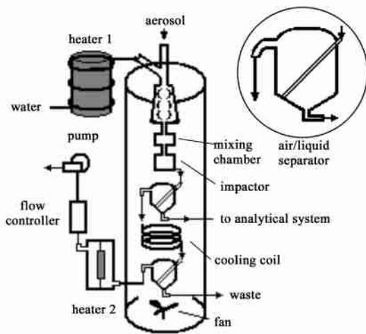
图5 蒸气冷凝大气颗粒物在线分析系统<sup>[37]</sup>
