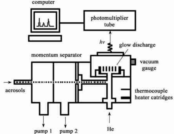
图7 粒子束空心阴极发射光谱仪<sup>[44,45]</sup>
