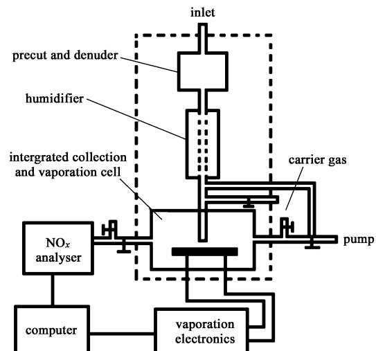
图4 大气颗粒物中硝酸盐自动测定期<sup>[36]</sup>
