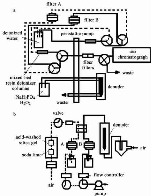
图 8 双通道自动湿式溶蚀器-离子色谱示意图<sup>[46]</sup>: (a) 分析系统,(b) 采样系统
