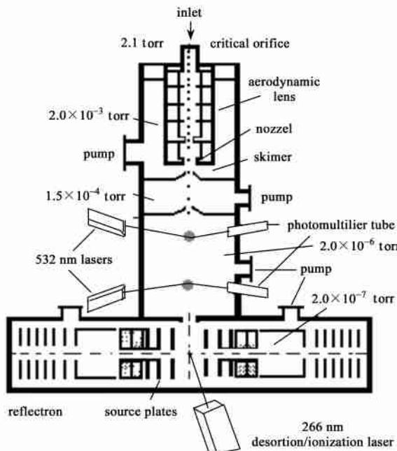
图 9 气溶胶飞行时间质谱仪示意图<sup>[48-51]</sup>
